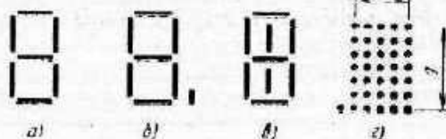
Рис. 3.25. Расположение светодиодных элементов в семи- (а), восьми- (б), десяти- (в) сегментном и матричном (г) индикаторах
