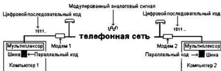
Рис. 21.2. Схема передачи кода по телефонной сети с использованием модема
