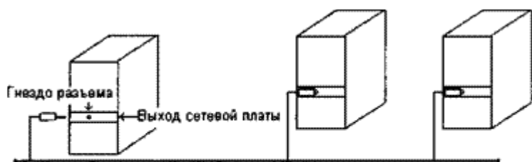
Рис. 21.1. Упрощенная схема подключения компьютеров к локальной сети
