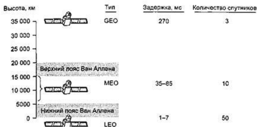
Рис. 2.13. Спутники связи и их свойства: высота орбиты, задержка, число спутников, необходимое для покрытия всей поверхности земного шара
