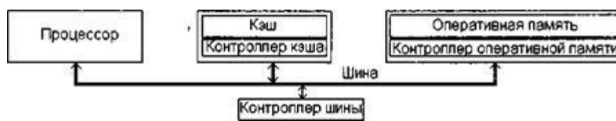
Рис. 12. Упрощенная схема взаимодействия процессора, кэша и оперативной памяти
