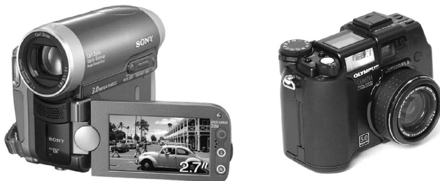
Рис. 14.29. Цифровая видеокамера и фотоаппарат, использующие ПЗС-матрицы в качестве входного регистрирующего устройства
