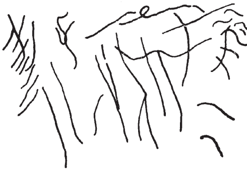
Рис. 3.31. Дислокации в почти совершенном кристалле кремния, наблюдаемые методом рентгеновской топографии [55]
