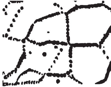
Рис. 3.29. Ямки травления, используемые для определения плотности дислокаций [52]
