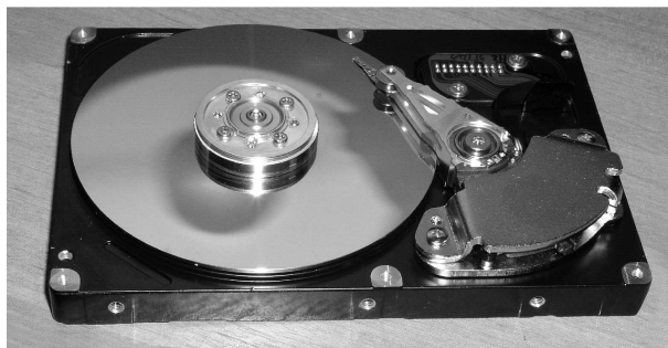
Рис. 7.23. Внешний вид винчестера со снятой крышкой
