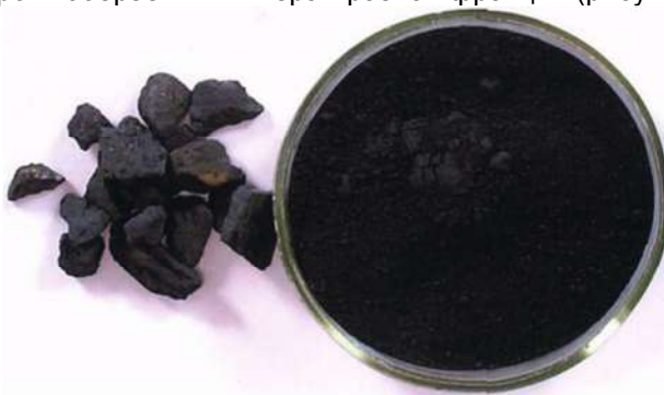
Рисунок 2 – Нативный и измельченный шунгит
