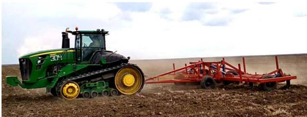
Рисунок 3 – Культиватор-плоскорез прицепной КПП-12 в агрегате с трактором Джон-Дир модели 8430Т на обработке пара в ТОО «Ново-Приречное»
