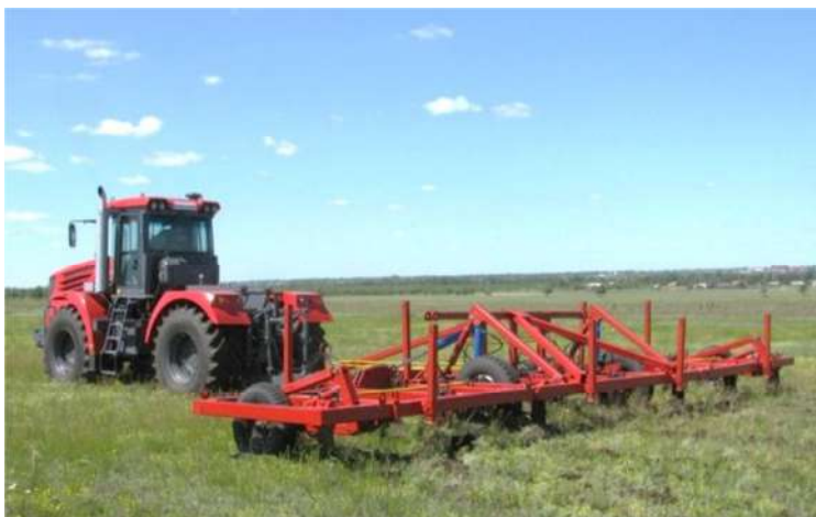
Рисунок 2– Культиватор-плоскорез прицепной КПП-12 в агрегате с трактором К-744РЗ на обработке парового поля в ОПХ «Заречное».
