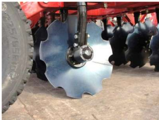
а – регулятор угла атаки дисков; б – стойки; в – опора подшипниковая; г – гидроцилиндр подъема в транспортное положение Рисунок 1 Дискатор Diskomaster-4,2×2
