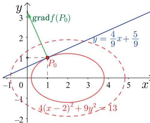
Рис. 3.16. Ортогональность  $\text{grad } f(P_0)$  и касательной к выделенной линии уровня
