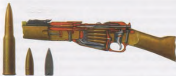
Бесатар мылтық. ҚР МОМ қорынан (КП 16787/13). Бесатар мылтықтың шүріппе жүйесінің қимасы, патроны және оғы. В.Ивановтың суретінен
