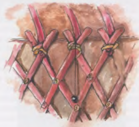
Кереге көгіне ілінген қыл жабысқан құмалаққа қарай ауадағы ылғалдық мөлшерін шамалайды. ҚР МОМ материалдары бойынша суретті салған Б.Досымов
