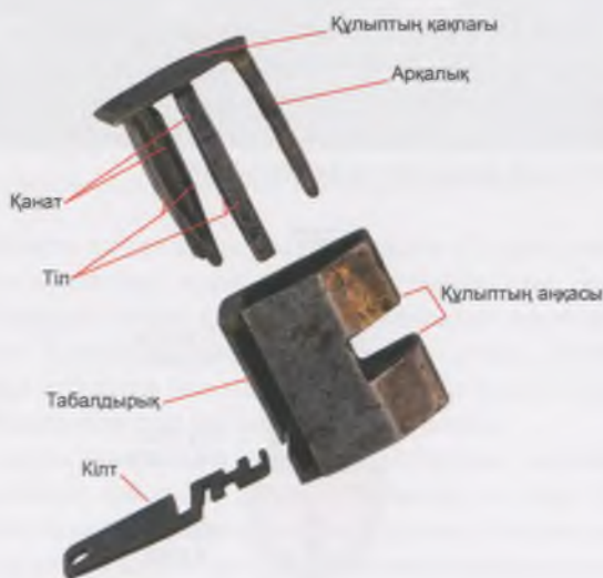
Тілшелі құлып және оның тілі мен кілті. Тілінің құлағы мен екі тілшесі бар. ҚР МОМ қорынан (КП 27758/1, 7, 9)
