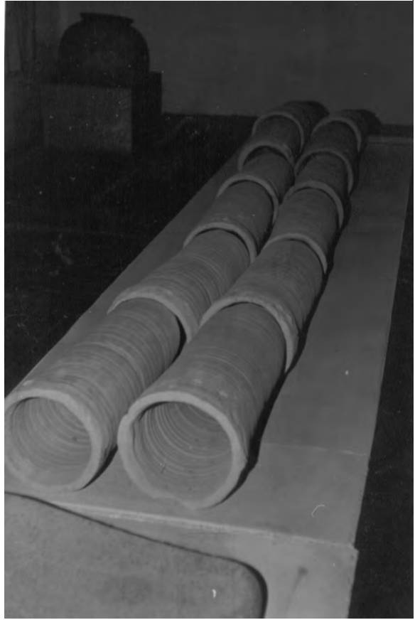
31-сурет. Орталық қыш су құбыр- ларының орналасу реті
