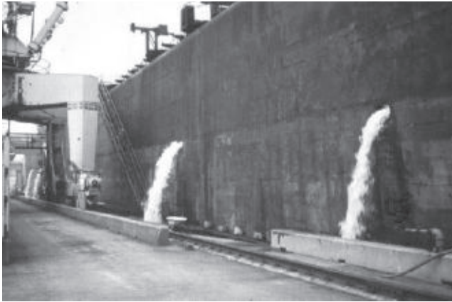
22.1-СУРЕТ. Айлаққа кірген кеменің балласт суы (Л. Дэвид Смит суреті. Northeast Sea Grant ұсынған)
