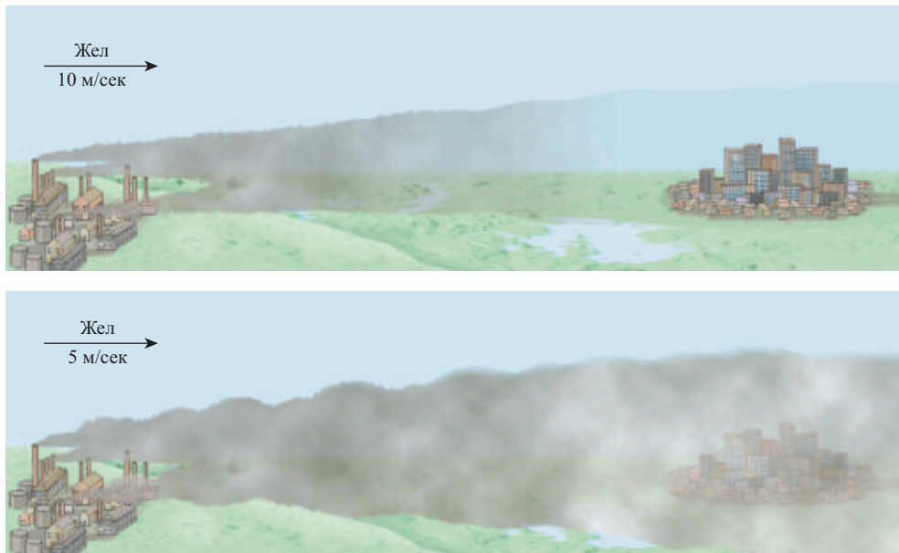
▲ 13.14-сурет. Ластаушы заттарды араластыру үшін жел жылдамдығының әсері. Ластаушы заттардың концентрациясы желдің жылдамдығы азайған сайын артады.
