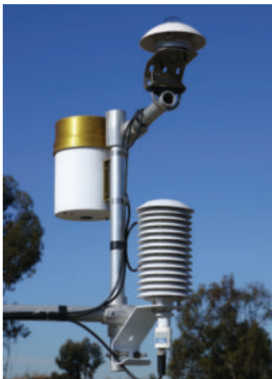
▲ 3.24-сурет. Температураны электрлік өлшеу. Бұл заманауи электрлік термометр терморезистор деп аталады.
