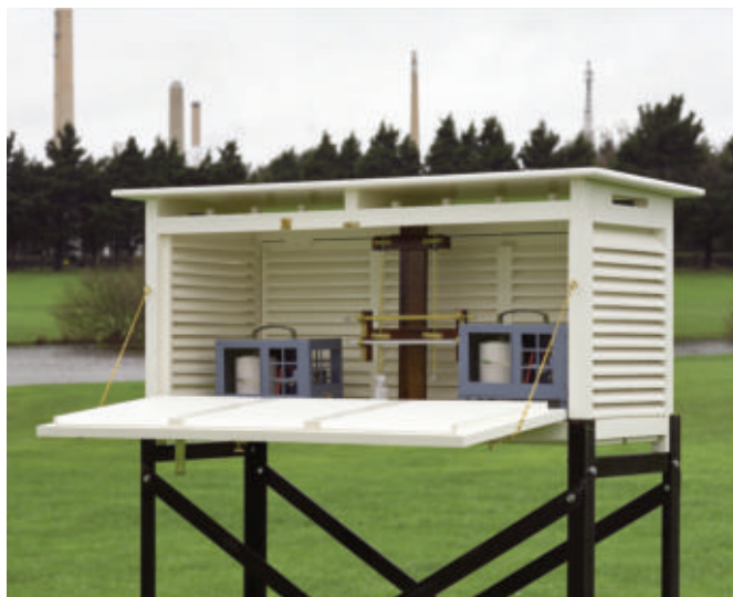
▲ 3.25-сурет. Стандартты құрылғы қорғанышы. Метеорологиялық будка ағаштан жасалып (ауа өту үшін), ақ түске боялады (жоғары альбедро үшін). Будка термометрді тіке күн сәулесінен және желден қорғап тұрады.
