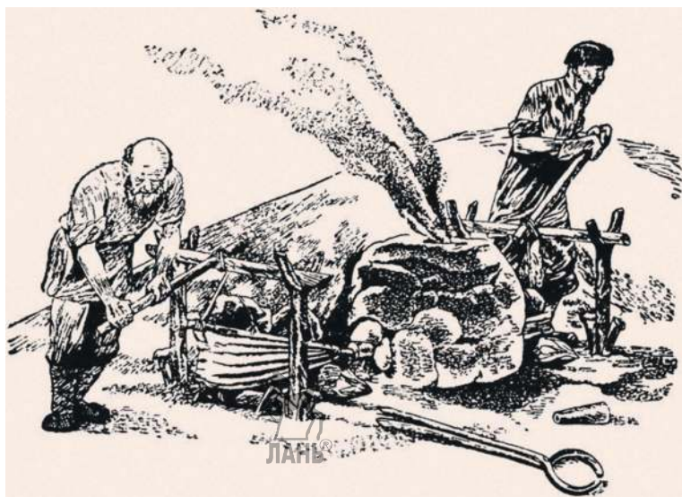
Рис. 3.29. Получение железа в домнице
