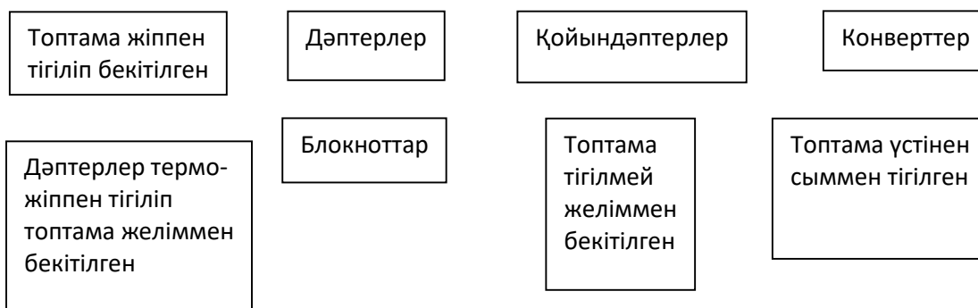
1-сурет. Кітапшалау-түптеу өндірісінің негізгі өнімдері және олардың түбінен бекітілу түрлері.
