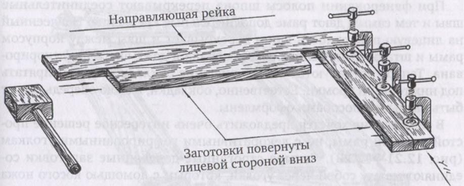
Рис. 12.19. Один из способов соединения сторон рамы
