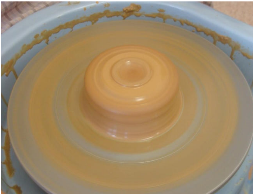
Рисунок 5. Отцентрированный комок глины (шайба), который получается в результате описанных в пояснениях к предыдущим рисункам действий. В центре видна впадина, образованная суставом большого пальца левой руки. Светлая покатая поверхность вокруг неё – след, оставленный лучезапястной частью правой руки
