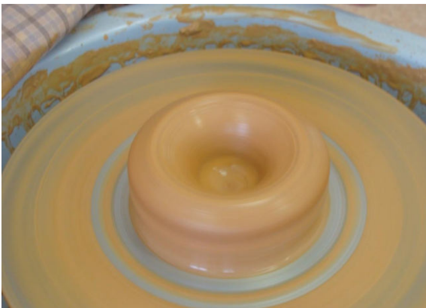
Рисунок 7. Глиняная шайба с отверстием посередине. Нижняя точка отверстия соответствует поверхности будущего дна
