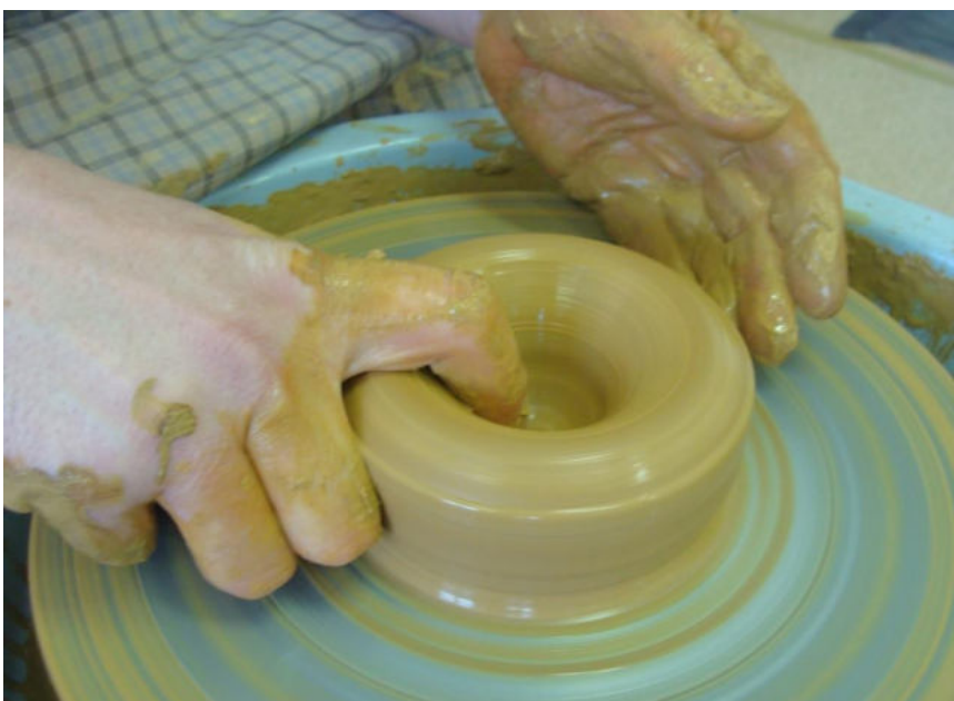
Рисунок 8. При помощи согнутого под прямым углом указательного пальца правой руки, усилие которой направлено к себе и одновременно против вращения вершинка, отверстие расширяется до размеров кольца
