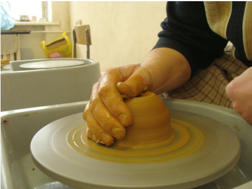
Рисунок 2. Положение, занимаемое правой рукой, скрытой от обзора в предыдущем рисунке. Видно, как сустав большого пальца намечает центр комка глины
