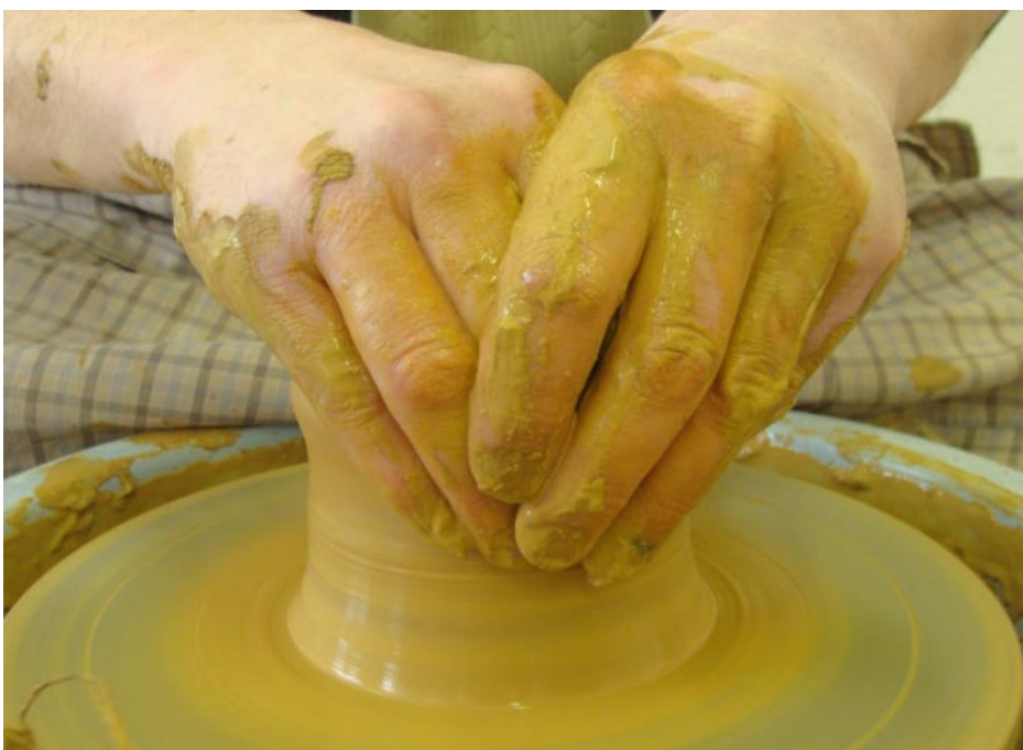
Рисунок 9. Кольцо, из которого начинают формироваться сначала стенки цилиндра, а затем изделие
