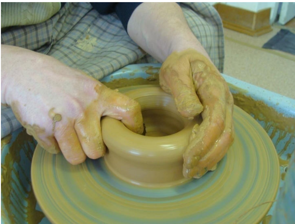
Рисунок 9. Кольцо, из которого начинают формироваться сначала стенки цилиндра, а затем изделие
