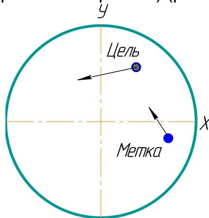
Рис. 6.8. Экран индикатора с функцией слежения с преследованием
