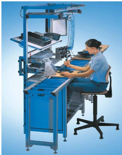
Рис. 5.14. Эргономичное рабочее место сборщика-электромонтажника
