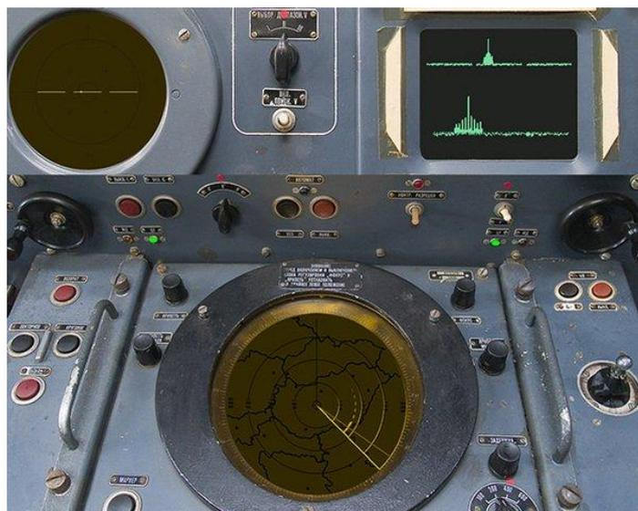
Рис. 6.3. Рабочее место оператора ПВО (слева и справа видны штурвалы для круговых движений органа управления)
