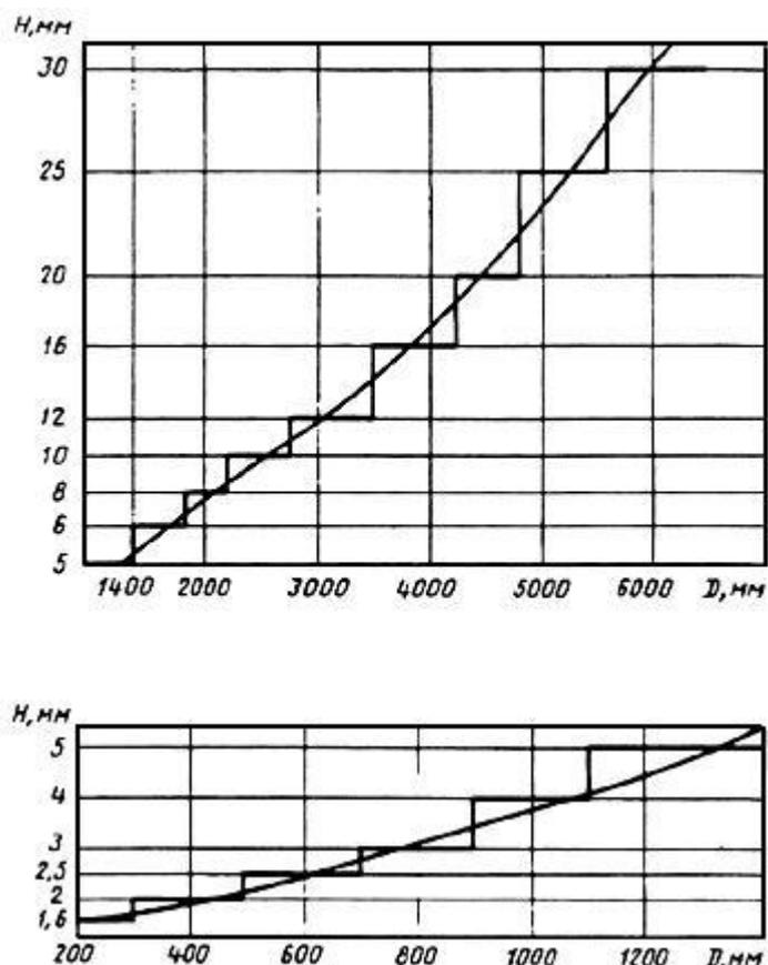
Рис. 4.14. Графики зависимости размера шрифта  $H$  от расстояния до прибора  $D$  (ГОСТ 5365-83)
