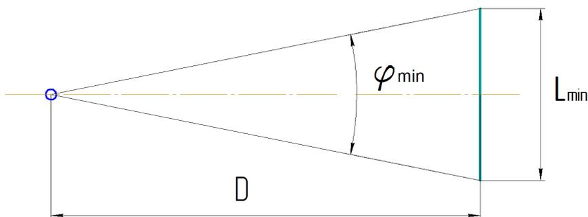
Рис. 4.6. Определение минимального угла зрения
