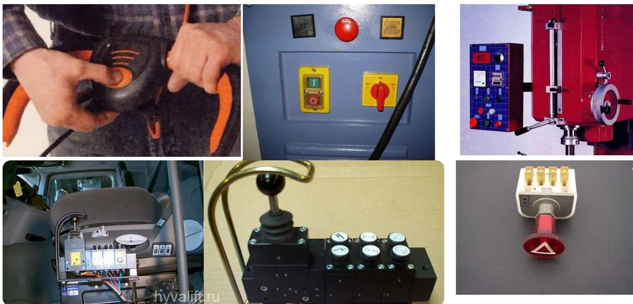
Рис. 6.11. Аварийные органы управления всегда выделены красным цветом, имеют больший по сравнению с другими размер. Для предупреждения непреднамеренного включения над органом управления устанавливают защитный кожух
