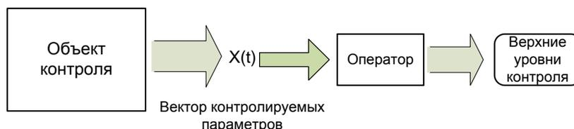
Рис. 3.3. Эргатическая система контроля
