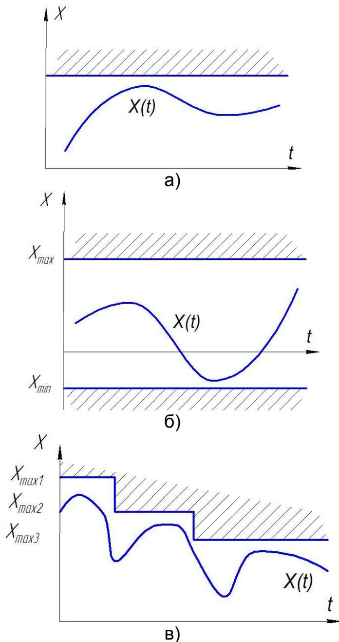
Рис. 6.10. Различные условия ограничений на перемещение рабочего органа
