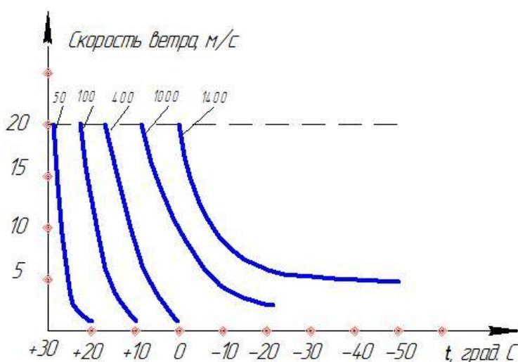
Рис. 7.7. Номограмма для определения ИОДВ по скорости ветра и температуре
