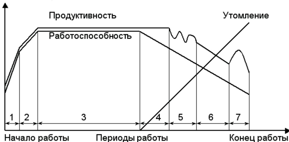
Рис. 8.2. График работоспособности человека: 1 – экстренное вработывание; 2 – тонкое вработывание; 3 – устойчивая работоспособность; 4 – полная компенсация утомления; 5 – неустойчивая компенсация утомления; 6 – падение продуктивности; 7 – “конечный порыв”.
