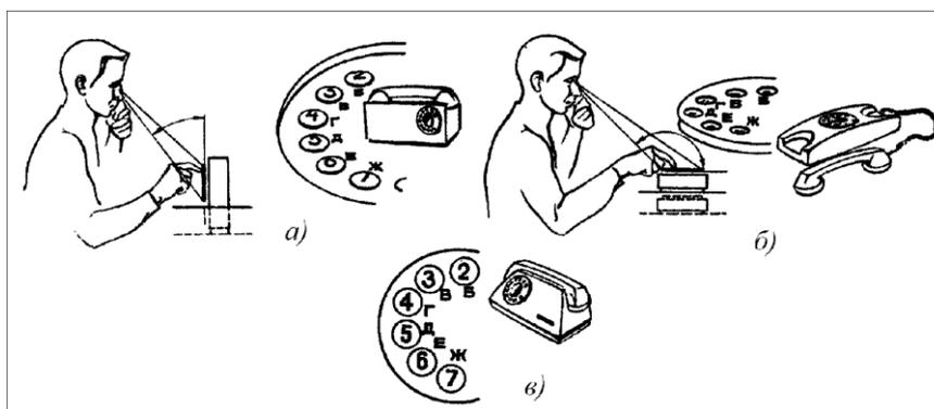
Рис. 4.9. Вид наборного диска телефонного аппарата при различных углах обзора
