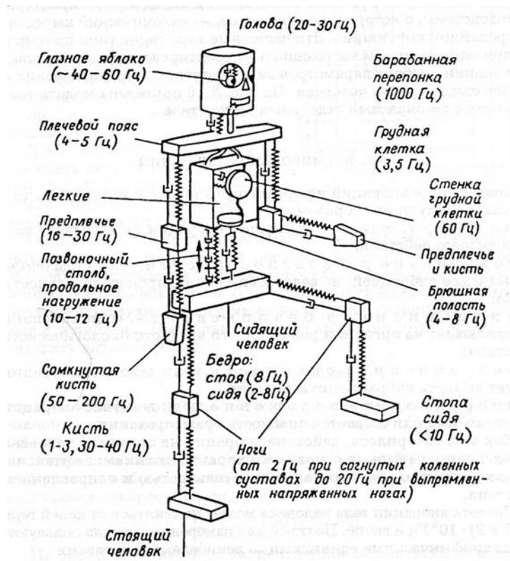
Рис. 7.11. Механическая модель колебательной системы человека и резонансные частоты частей тела
