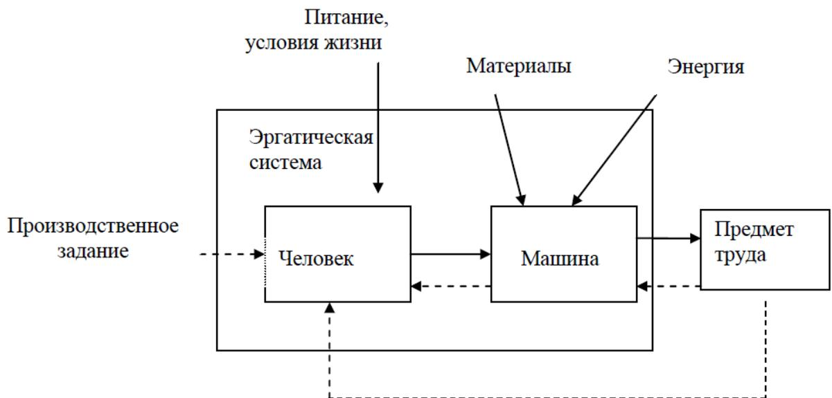
Рис. 3.1. Структурная схема эргатической системы
