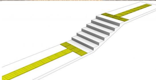
Рис. 4.22. Тактильная плитка на тротуарах и станциях
