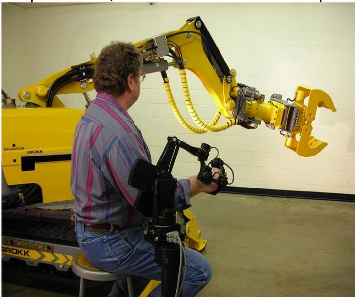
Рис. 4.20. Работа с копирующим манипулятором
