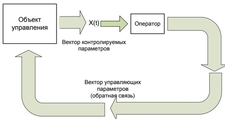
Рис. 3.4. Эргатическая система управления
