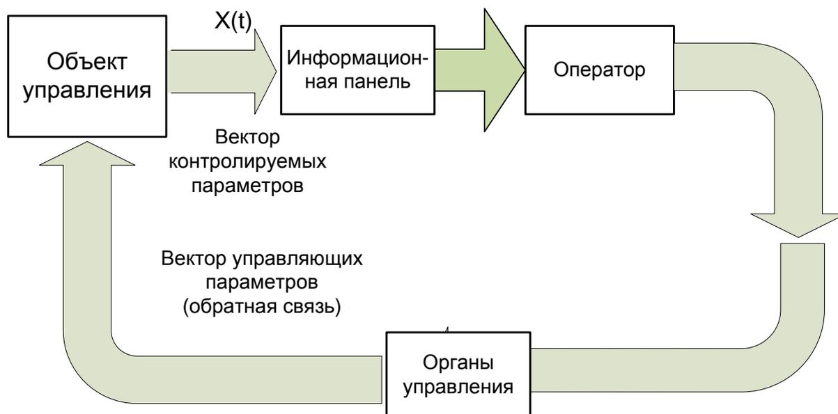
Рис. 3.6. Эргатическая система как аналог автоматической системы управления
