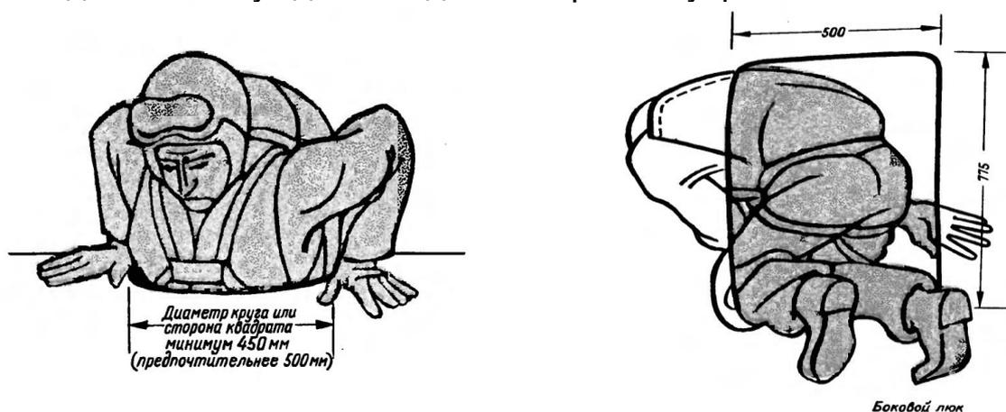
Рис. 5.10. Учет размеров человека при определении размеров люка
