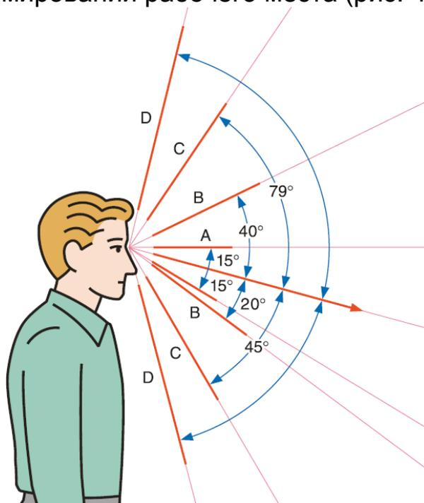
Рис. 4.5. Границы поля зрения с учетом наклона головы (границы А - оптимального поля зрения, В – ясного зрения, С - максимального зрения, D - расширенного поля зрения за счет движения головы)
