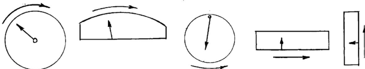
Рис. 4.7. Направление движения стрелки прибора при возрастании показаний
