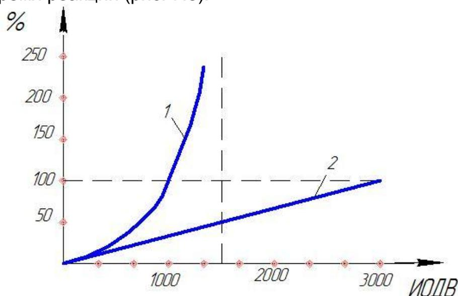
Рис. 7.8. Зависимости ухудшения характеристик оператора от ИОДВ: 1 - тактильной чувствительности, 2 - времени реакции
