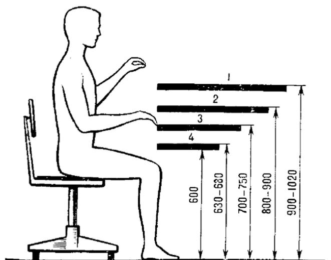
Рис. 5.16. Рекомендуемая высота рабочей поверхности для разных видов и точности работы: 1 — очень точные и тонкие; 2 — точные на пультах; 3 - конторские; 4 - клавиатура компьютера
