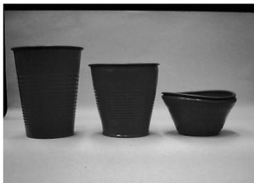
*Рис. 13. Различная степень коробления изделий при разных температурных условиях их эксплуатации*
