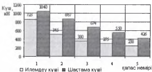
3.7-сурет– Илемдеу күштері мен шақтама күштерді қапастар бойынша тарату
