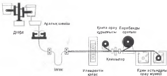
1.12-сурет – Крефельдтегі жұқа жолақ құятын қондырғының жабдығының орналасу сызбасы
