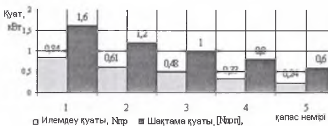
3.9-сурет – Құрылымы бойынша жаңа орнақта илемдеу кезінде қапастар бойынша илемдеуге қажетті қуаттарды және шақтама қуаттарды тарату
