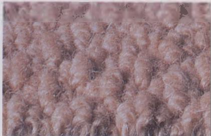
Существует много методов исполнения многоуровневых структур напольного покрытия. При одних методах петли обрезаются, и тем самым ковру придается особенный вид. При классическом методе обрезных петель обрезают длинный ворс.
