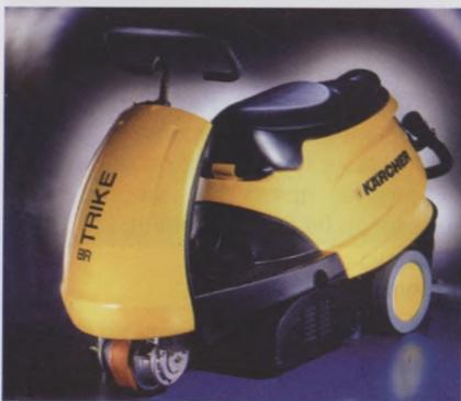
**Большие автоматические машины** для уборки изготавливаются с сиденьем для сотрудника и рулевым управлением. Они достигают скорости до 6 км/час за счет встроенного мотора.
