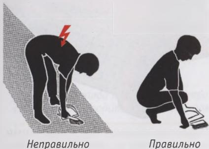
При включении прибора в розетку следует присесть
