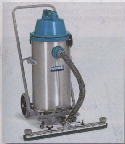
Всасываемый воздух напитывается влагой, поэтому он непригоден для охлаждения мотора. Системы всасывания и охлаждения мотора отделены друг от друга байпасом. Клапаны для остановки пены или воды автоматически перекрывают поток всасываемого воздуха.
