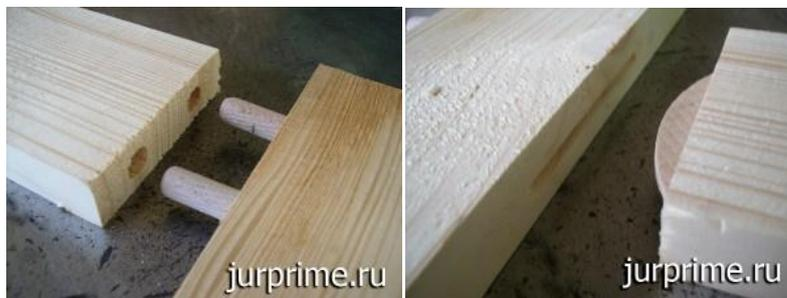
Так, например, при ширине заготовок 60 мм мы можем вставить только 2 шканта. Пусть это будет шкант 6 x 40 мм. Таким образом, площадь склеивания составит  $2 \times 3,14 \times 3 \times 40 \times 2 = 1507$  мм кв., а при сквозном шипе площадь склеивания будет 7200 мм кв. Это без учёта торцевой поверхности. Вот и сравните!
