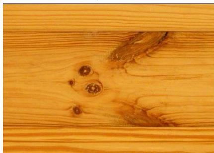
Обычные сучки снижают ценность древесины, идущей под прозрачную отделку, не рекомендуется в несущих элементах конструкций применять невысушенную древесину с сучками, так как, высохнув, сучок теряет связь с основой и ослабляет конструкцию. В таких случаях сучки высверливают и в отверстие вставляют на клею сухие заглушки.
