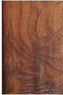
**Свилеватость** – волнистое размещение волокон, особенно в прикорневой части дерева. Чаще всего свилеватость наблюдается у дуба, клёна, ореха и др. Древесина с этим пороком труднее поддается обработке.
