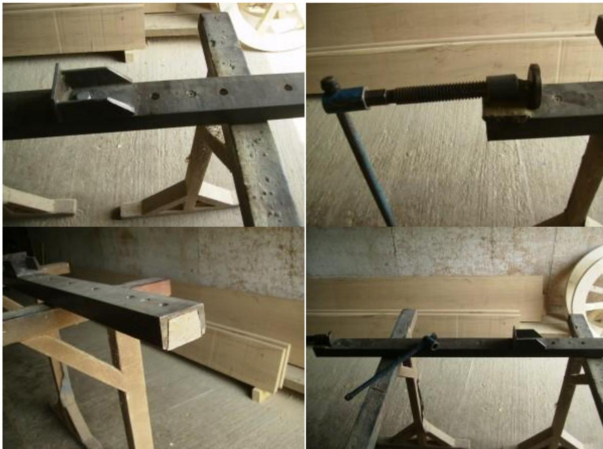
На фото сверху вниз показаны : — передвижной упор, — винтовой зажим, — брусок увеличивающий жёсткость и долговечность струбцины, — общий вид ваймы и ключ для зажима.
