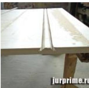
Я лично делаю пазы с помощью ручной дисковой пилы. Это даёт мне возможность делать ласточкин хвост с наклоном 45 градусов, тогда, как фрезки на ручные фрезера имеют наклон 12-14 гр. Причём и вставной брусок в этом случае нужно делать также ручным фрезером, потому что найти фрезу на большой фрезер с углом 14 гр. крайне сложно.
