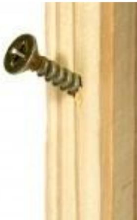
Одним из важных технологических свойств древесины является её **способность удерживать металлические крепления** - гвозди, костыли, скобы, шурупы и т.д.
