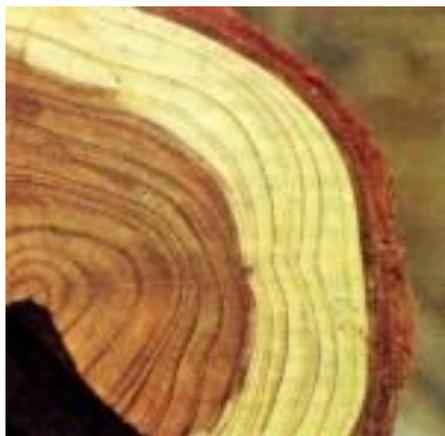
Древесина различных пород имеет разную *плотность*. Плотность зависит от тех веществ, которые образуют клетку. Плотность бывает *условной и средней*. *Условная плотность* — это отношение минимальной массы к максимальному объёму образца. *Средняя плотность* зависит от влажности и пористости древесины. Её значение указывается относительно к 15% влажности.
