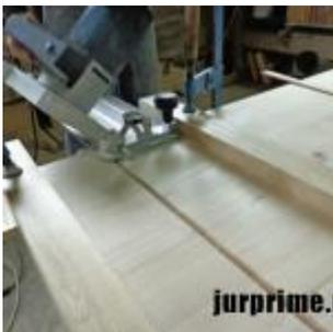
Паз под «ласточкин хвост» делается на нижней стороне столешницы. Если Вы будете утолщать столешницу, то паз можно делать сквозным, а брусок вставлять так, чтобы до края столешницы оставалось 2-3 см. Если столешница не утолщается, то паз делается несквозным с одной стороны, а брусок после установки подпиливается и скалывается так, чтобы он свободно прошёл между царгами стола. Паз в этом случае со сквозной стороны заделывается вставкой, подобранной по цвету и структуре.
