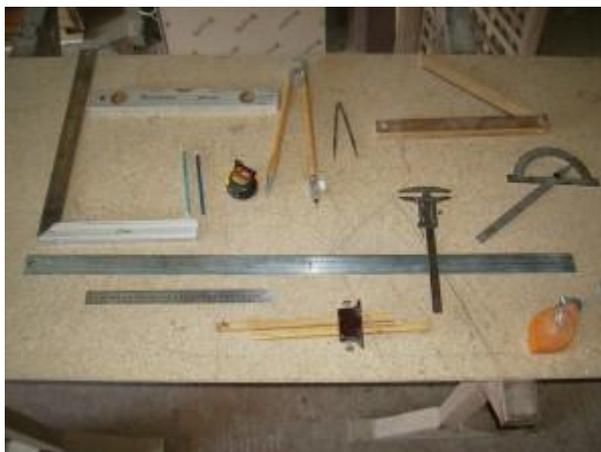
*На фото показаны основные приспособления, которыми пользуются столяра для разметки древесины.*
