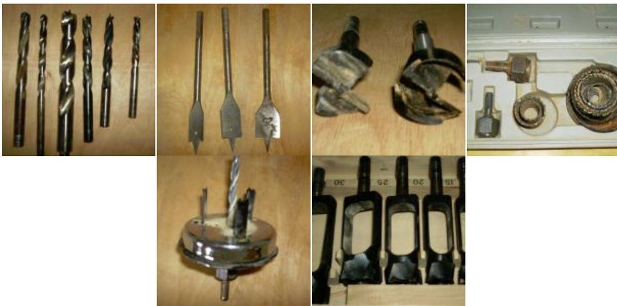
Слева направо и сверху вниз: свёрла спиральные с разной заточкой, свёрла центровые, свёрла пробковые (обратите внимание — разных модификаций, левые лучше точатся, правые точнее сверлят), набор свёрл для изготовления пробок, набор коронок, сверло с изменяемым диаметром сверления.
