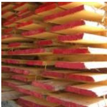
**Как выбрать материал для столярных изделий.** Ну, естественно, что столярку изготавливают в основном из *досок*. И так. *Доской* принято считать пиломатериал, толщиной до 100 мм и шириной более двойной толщины.
