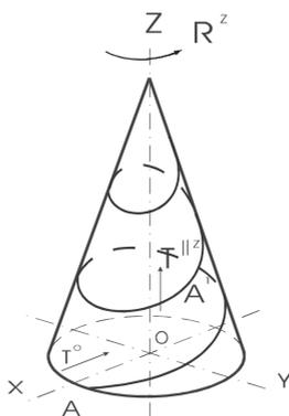
$R^z$  – поворот вокруг оси  $Z$ , траектория непрерывного движения – коническая винтовая линия. Функции зависимостей поворотов и переносов могут носить как пропорциональный (линейный), так и непропорциональный (нелинейный) характер.
