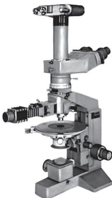
**Л. А. Гаккель, В. А. Цепов. Поляризационный рудный микроскоп ПОЛАМ Р-312, 1973 г.**
