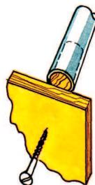
Рисунок крепления плоскости щита к торцу трубы
