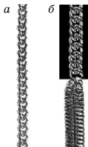
Рис. 10.24. Цепочка до (а) и после (б) уплотнения
