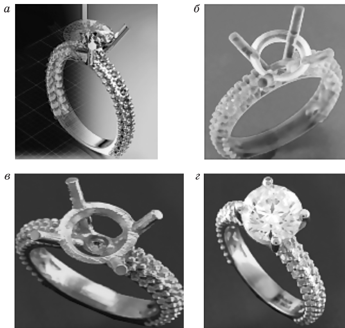
Рис. 5.9. Этапы изготовления модели методом 3D-моделирования: а — виртуальная трехмерная модель; б — модель из полимера; в — отливка; г — готовое изделие
