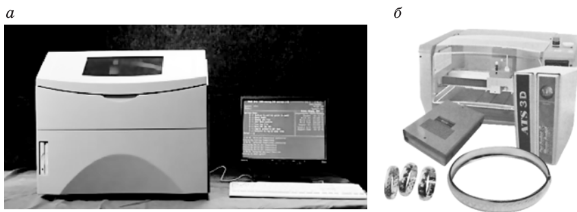
Рис. 5.8. Установка для моделирования Solidscape (а) и устройство для трехмерного моделирования FOV MODELLING 4A-RI с моделями изделий (б)
