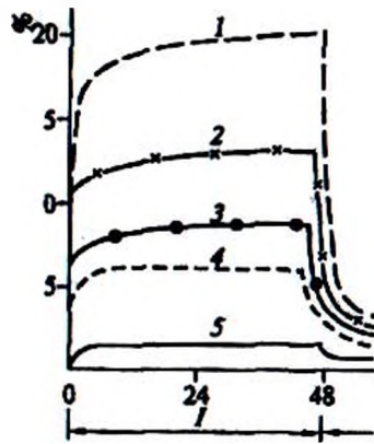
Сурет 3.29 – Мата бойындағы ылғал булардың сорбция және десорбция бойынша қисық сызығы 1-вискоза, 2-табиғи жібек, 3-мақта матасы, 4-капрон, 5-лавсан.
