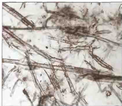
1.24 сурет. Баланстардан алынған механикалық массаның талшықтары (110 есе үлкейтілген)
