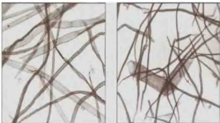
1.14 сурет. Жұмсақ қылқанды сүректің (а) және катты сүректің (б) талшықтары
