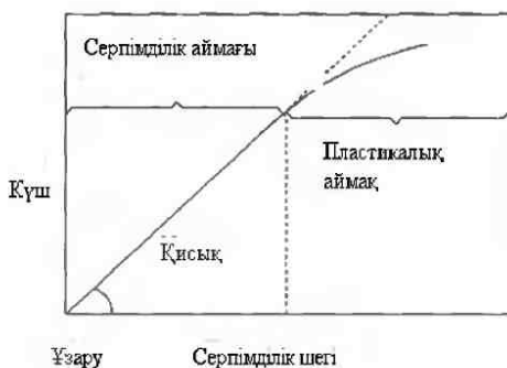
1.59 сурет. Серпімді эластикалық қасиеттерді көрсететін деформация қысымының тәуелділігі
