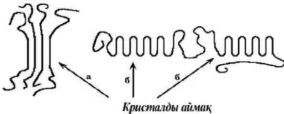
3.3 сурет: Полимер бөлігіндегі кристалды аймақтардың құрылымдық түрлері: а) фибриллярлы құрылым; б) қоймалы құрылым
