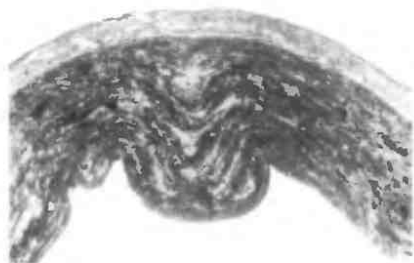
1.66 сурет. Бүтілген кезде қабат ажырауының микросуреті
