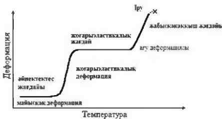
3.4 сурет. Полимердің физикалық жағдайының температураға тәуелділігі
