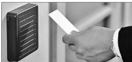
Рис. 3.4. Бесконтактная запирающая система с проксимити-картой
