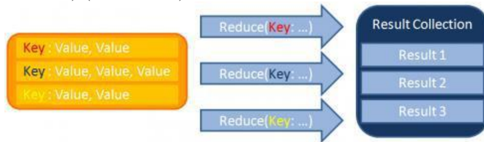
Рисунок 2.25. Исполнение функции Reduce, возвращающей коллекцию всего массива данных по запрошенному ключу.
