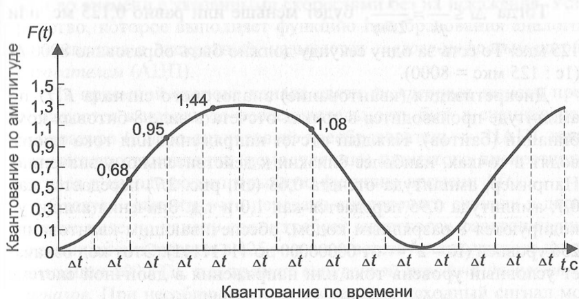
Рис. 2.7. Эпюра дискретизации аналогового сигнала
