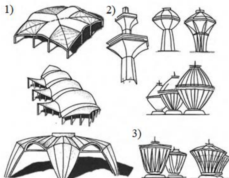
11-сурет. Жұқа қабықты аралас қабықшалардың мысалдары: 1 – жабынды; 2 – мұнараларды; 3 – су жинақтауыштар
