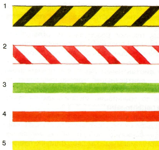
Рисунок 4.6 - Использование цвета в технической индикации: 1, 2 – сигнал опасности, предупреждения; 3, 4, 5 – трубопроводы нейтральной и горячей жидкостей, газа.
