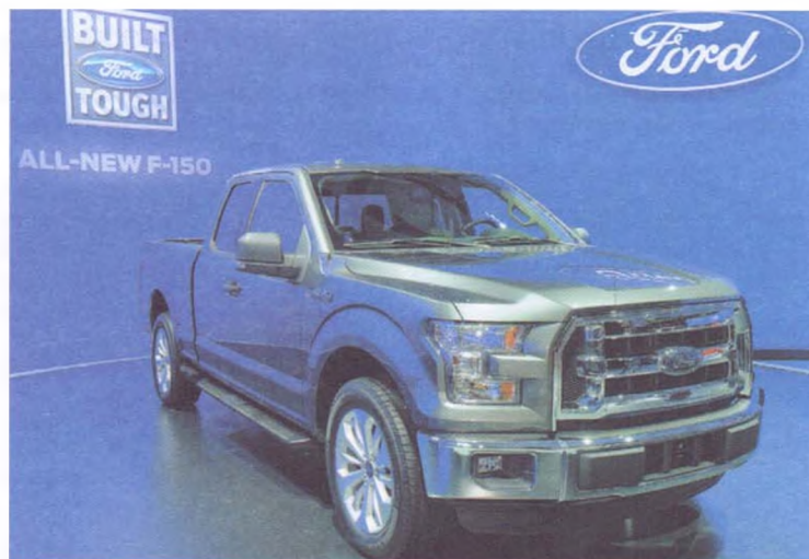
Барлық жаңа 2015 Ford F-150 көліктерінде әдеттегі болаттың орнына алюминий пайдаланылды. Шешім тәуекел деңгейі бойынша қабылданды.
