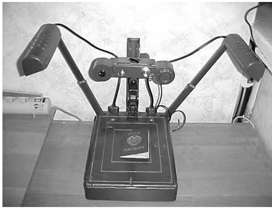
25-сурет. Репродукциялық суретке түсіруге арналған шағын С–64 қондырғысы.
