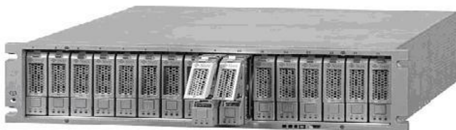
Рисунок 10.3 - Типичная Система хранения данных начального уровня (Sun StorageTek 6140)
