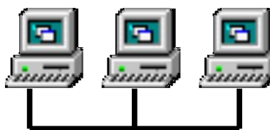
Рисунок 7.1 - Простая сеть с топологией «шина»
