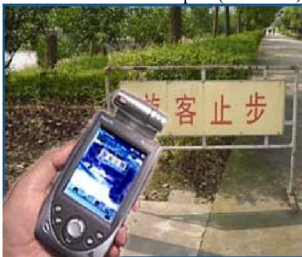
Рисунок 2.26 - Устройство перевода символов
