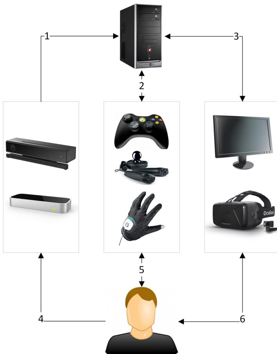
Рисунок 4.14 - Визуальная схема взаимодействия устройств и пользователя (технический аспект архитектуры системы)
