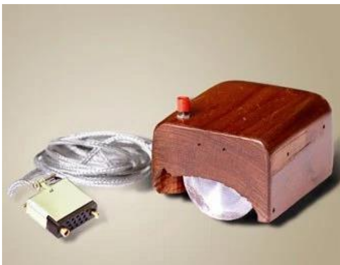
Рисунок 4.3 - Первая компьютерная мышь (1964 год)
