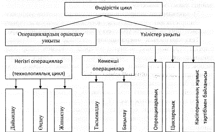
4-сурет – Өндірістік циклдың құрылымы
