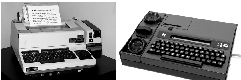
Рисунок 1.16 – Электронная шифровальная машина Aroflex (США) и портативная электронная шифромашинка HG-530/535 семейства CRIPTOMATIC 500 Бориса Хагелина (Швейцария)
