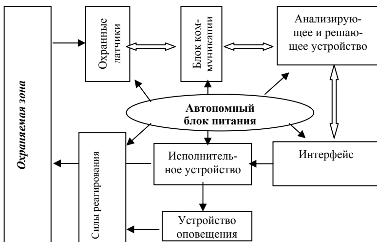
Рис. 6.34. Структурно-функциональная схема системы охраны
