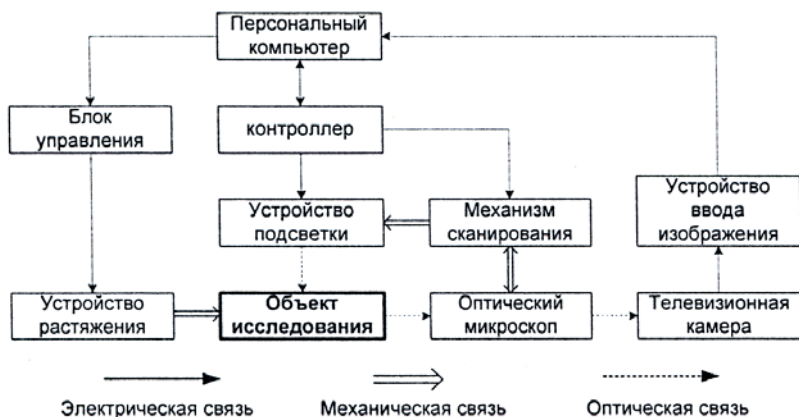
Рис. 6.22. Обобщенная структурная схема ОТИС
