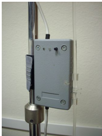
Рис. 6.12. Выносной модуль интеллектуальной мехатронной системы контроля процедуры инфузии
