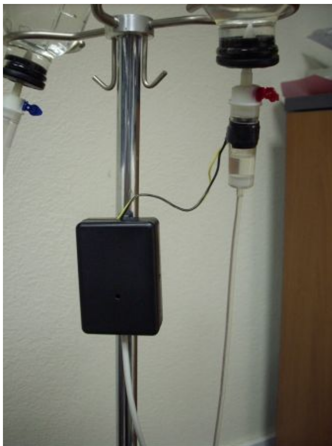
Рис. 6.16. Емкостной флуктуационный датчик интеллектуальной мехатронной системы контроля процедуры инфузии
