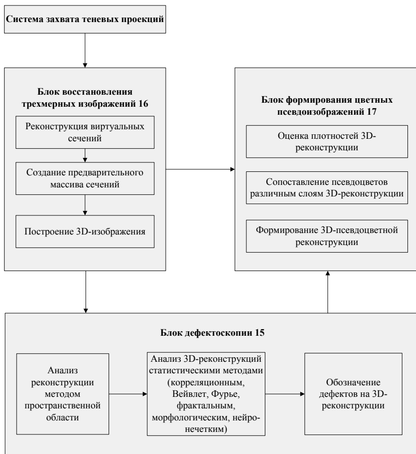
Рис. 6.31. Структурная схема программного обеспечения анализа 3D-изображений
