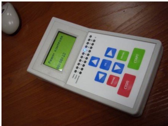
Рис. 6.14. ПСИ интеллектуальной мехатронной системы контроля процедуры инфузии
