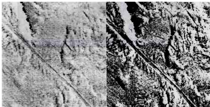
Рис. 6.25. Результат бинаризации с локальным порогом исходного и сглаженного изображений стали
