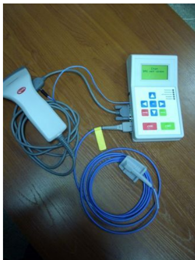
Рис. 6.13. АЭМ интеллектуальной мехатронной системы контроля процедуры инфузии
