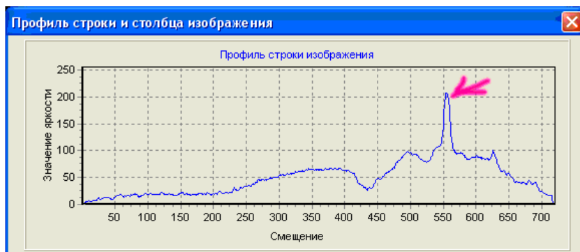
Рис. 6.4. Профиль строки синей компоненты изображения, содержащего блик. Пик яркости, соответствующий блику, отмечен стрелкой
