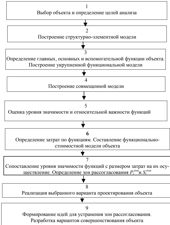
Рис. 5.12. Блок-схема алгоритма экспресс-ФСА
