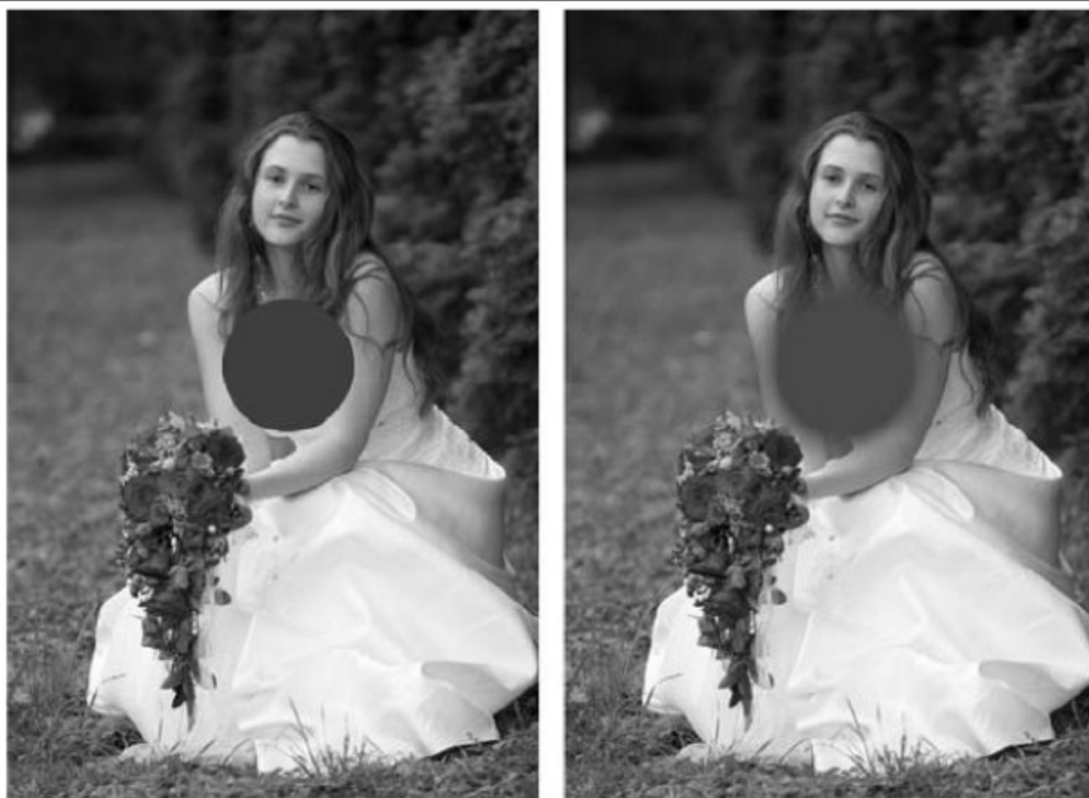
Рис. 3.10. PNG с индексированной палитрой и полупрозрачностью в Internet Explorer 6.0 и в остальных браузерах
