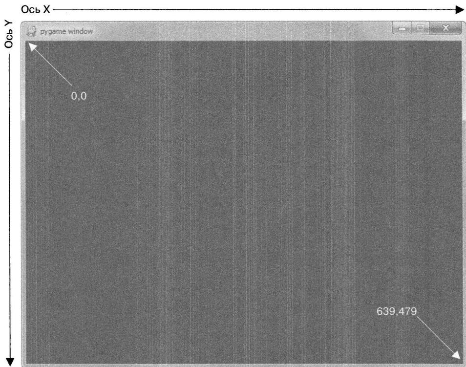
Рис. 11.5. Точки на графическом экране описываются парами чисел: абсциссой и ординатой
