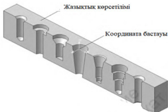
3.50-сурет. Саңылау операциясымен орындалатын саңылаулардың кейбір түрлері
