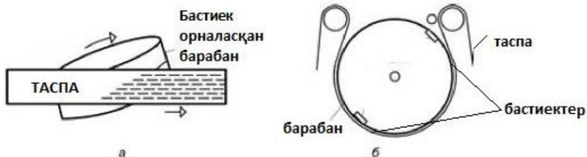
7.36-сурет. Сызықты көлбеу жазу принципі: а) жазу принципі; б) барабанның таспаны қапсыруы
