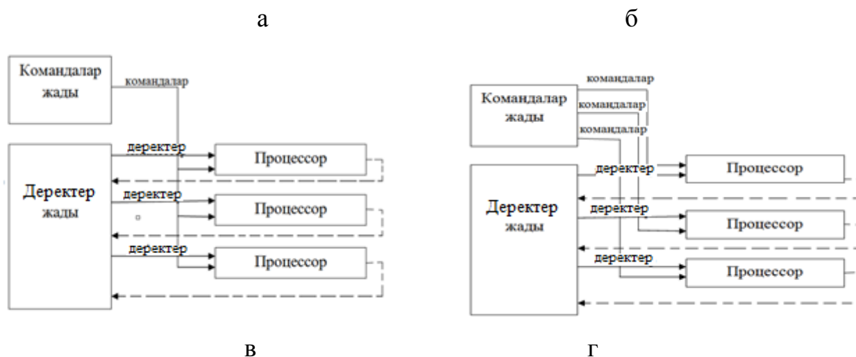
12.4-сурет. Флинни жүйесі бойынша ЕЖ сәулеттері: а - ЖКЖД (SISD); б- ККЖД (MISD); в - ЖКҚД (SIMD); г – ККҚД (MIMD).
