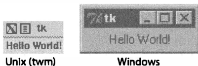
Рис. 5.1. Графический элемент Label интерфейса Tkinter
