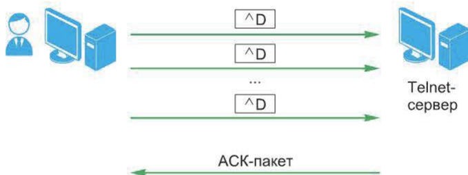
Рис. 12.3. Обнаружение уязвимости Sun Telnet DoS Attack
