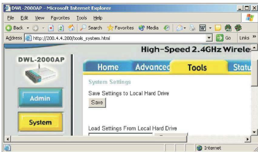
Рис. 20.1. Сохранение конфигурации точки доступа D-Link DWL-2000AP
