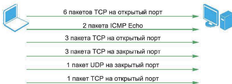
Рис. 9.10. Определение ОС с помощью утилиты nmap
