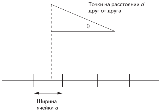
Рис. 3.13. У двух точек, отстоящих друг от друга на расстояние d \gg a , мало шансов быть хэшированными в одну и ту же ячейку
