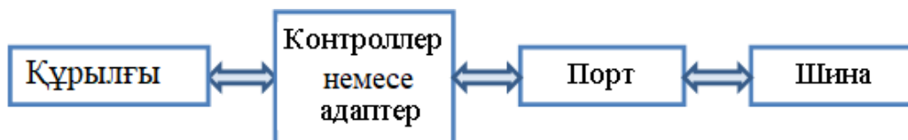
2.4-сурет – Құрылғының құрсымға қосылу кестесі
