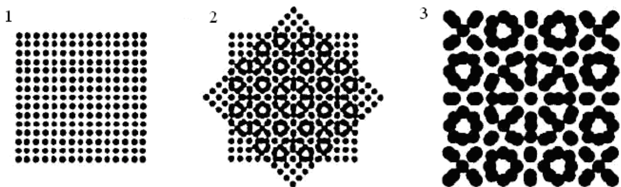
Рис. 5.6. Механизм образования муара: 1) растровая решетка; 2) наложение двух растровых решеток, повернутых относительно друг друга на некоторый угол; 3) увеличенный центральный фрагмент проявляющегося муара
