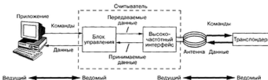
**Рис. 4.1.** Схема взаимодействия приложения, считывателя и транспондера
