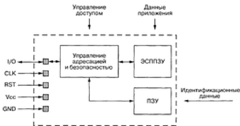
**Рис. 6.6.** Типичная архитектура смарт-карты с микросхемой памяти, схемой безопасности и контактным интерфейсом
