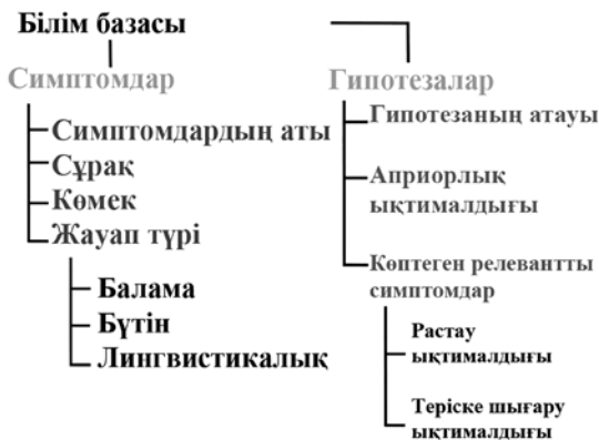
2.4-сурет. BESS жүйесінің білім базасының құрылымы
