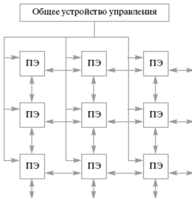
Сурет 8.2. Матрицалық есептеу жүйесінің құрылымы SOLOMON
