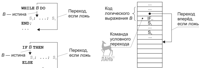
Рис. 3.8. Схема трансляции логических выражений
