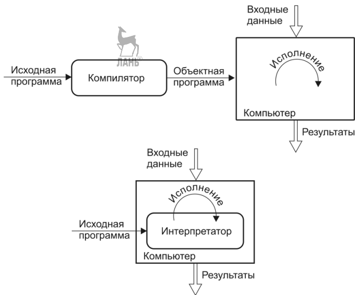
Рис. 1.1. Схема работы компилятора и интерпретатора
